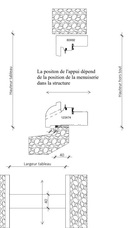
La position de l'appui dépend de la position de la menuiserie dans la structure
